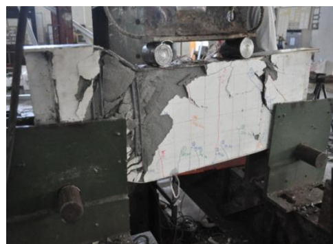
Gambar 6. Mekanisme Kerusakan Benda Uji BC dan BK
